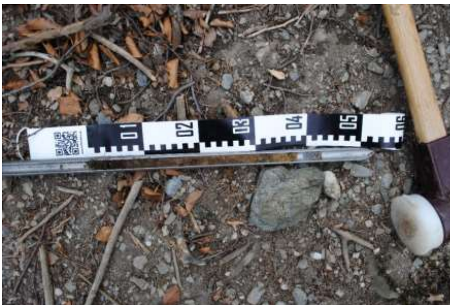
3. ábra: Pürkhauer-fúróval kivett talajminta
