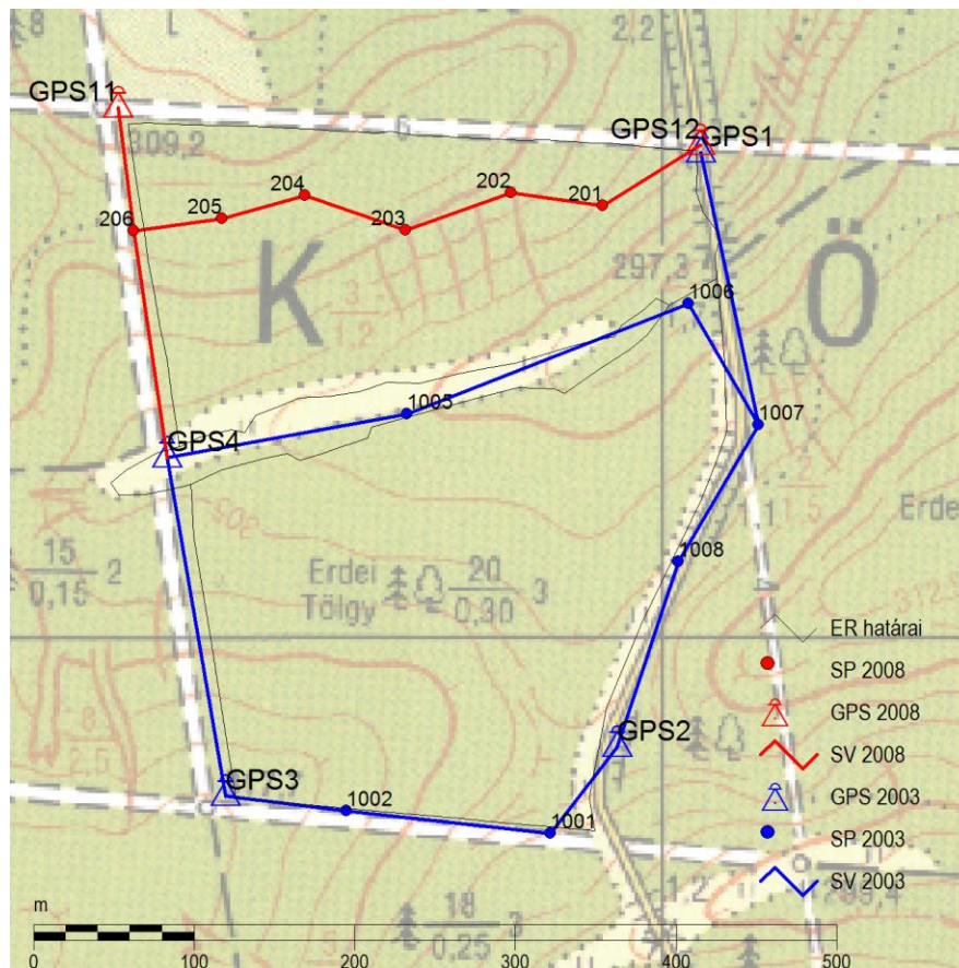
7. ábra: A GPS alappontok és a sokszögelés vázrajza Fig. 2.: Sketch of the GPS-points and the traverse between them
