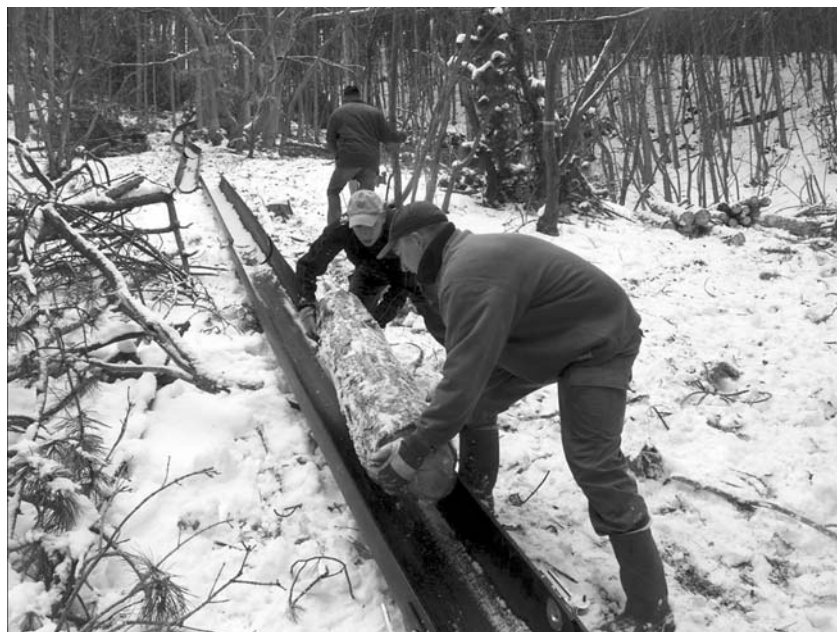
4. ábra. Mobil erdészeti csúszda.
