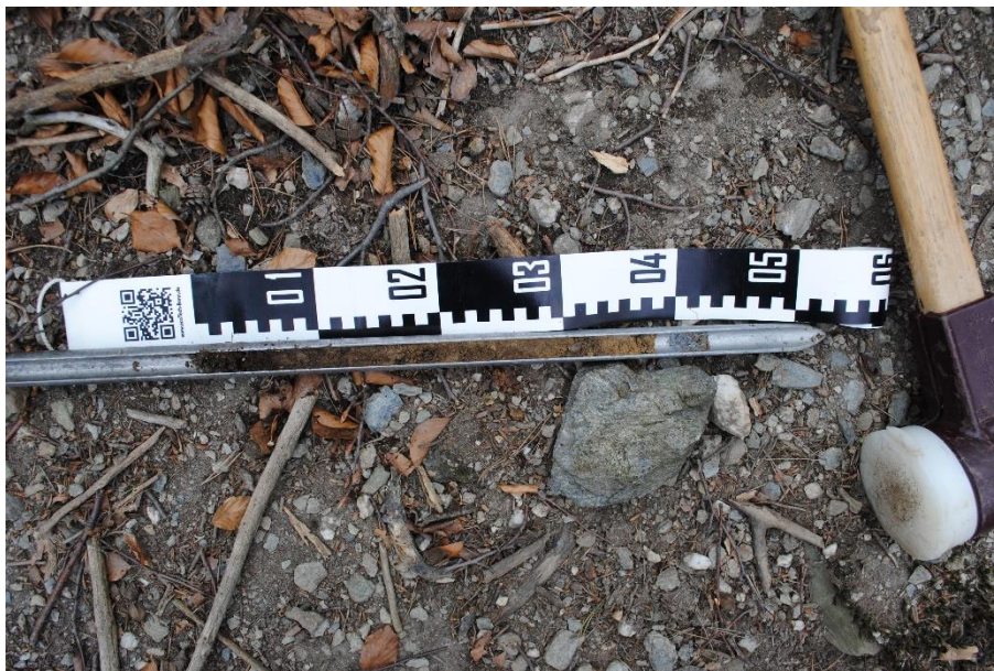
9. ábra: Pürkhauer-fúróval kivett talajminta
